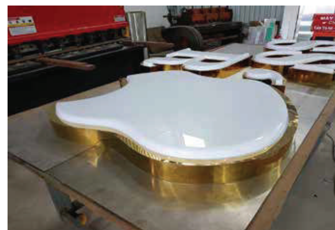
104. Chữ inox vàng uốn hộp mặt mica hút nổi đèn led
